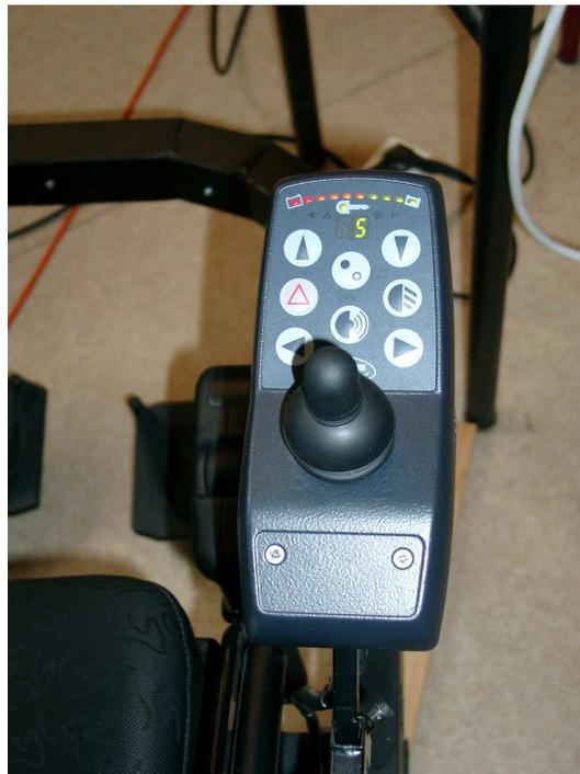
FIG. 5 – Boîtier de commande en mode automatique en état de fonctionnement normal
